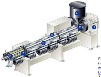
Figure 2: Single-screw extruder (Reifenhäuser Group at www.reifenhauser.com/en/extruder/p 0056\_ein\_module.asp)
