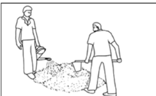
Pour water onto the dry mix
