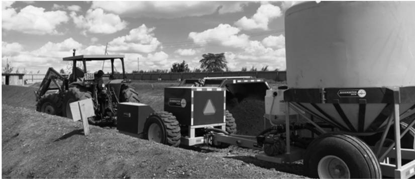
**Foto 10.1** Usina de compostagem com sistema de leiras revolvidas de Sanergy, Nairóbi
